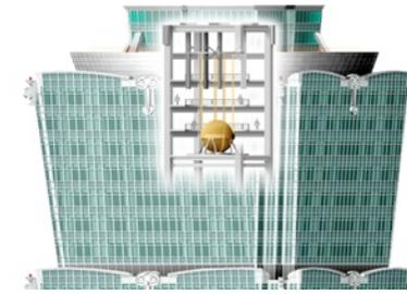
**La tour Taipei 101**, de 509 m de haut, construite à Taïwan, est située dans une zone où les séismes sont fréquents. Elle utilise de nombreuses techniques parasismiques, comme par exemple une sphère stabilisatrice de 660 tonnes suspendue au 92<sup>ème</sup> étage, et qui contrebalance les vibrations causées par les séismes ou les typhons. La tour a déjà résisté à un séisme survenu pendant sa construction, en 2002.
